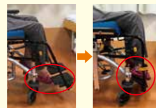
極限まで手前に引き込んだ「直下構造のフットサポート」(前後・角度調整式)
